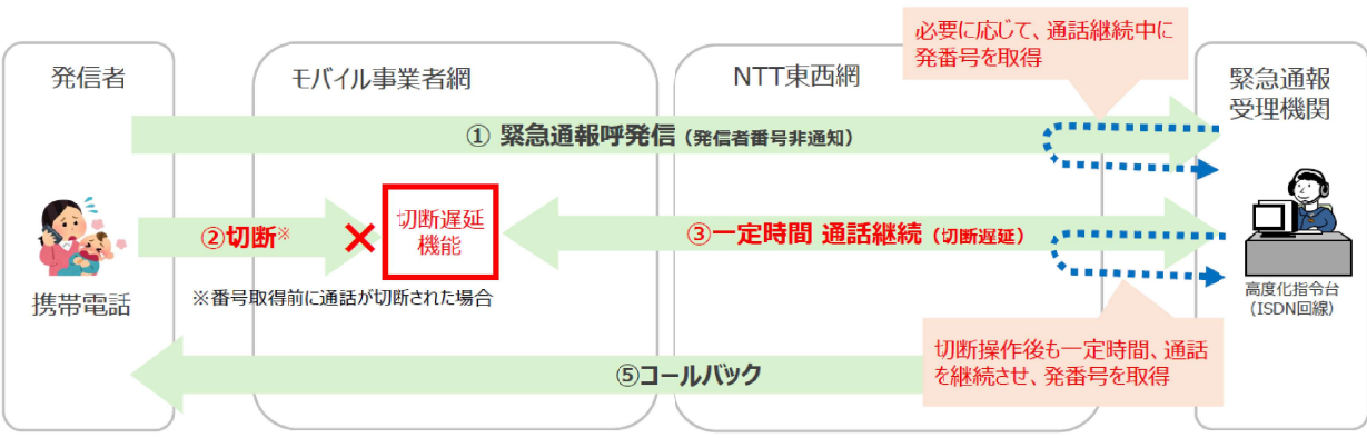
■ モバイル発緊急通報呼における「切断遅延機能」の仕組み（発信者番号非通知呼※の場合）
