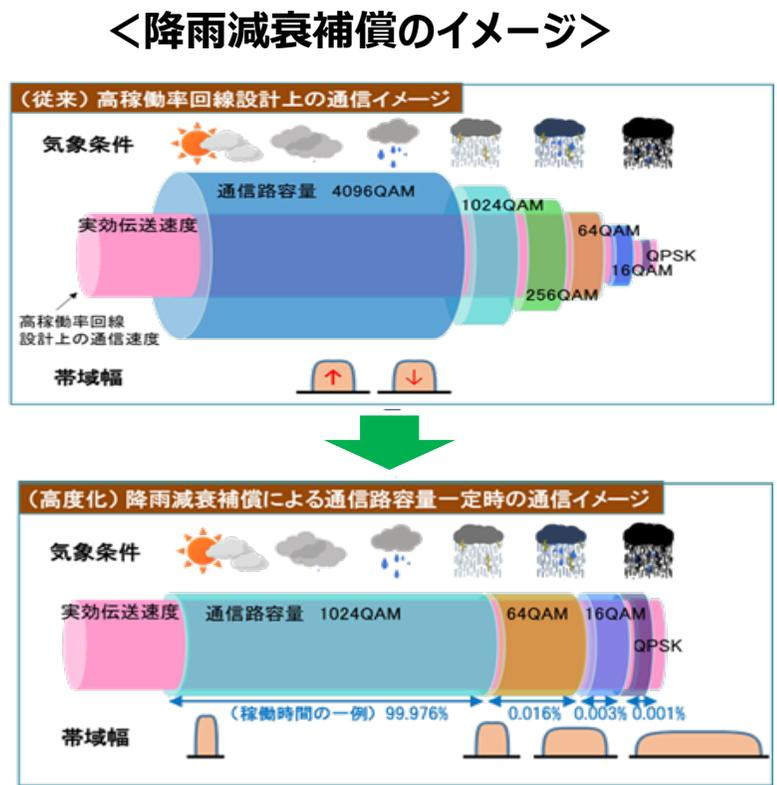
現行の26GHz帯FWAではバックホール回線などの用途で使用しているため、移行先候補となる22GHz帯FWAでも安定した伝送速度の実現が必要であり、伝搬環境の悪いケースを想定した大容量伝送技術等を実現すべく、高度化システムに求められる機能に必要な要求条件について検討した。
