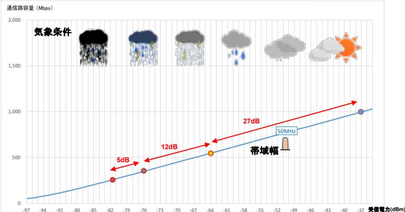
(従来方式) 高稼働率回線設計上の通信イメージ
