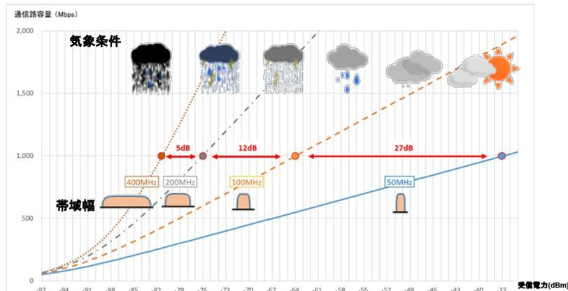
(FWA高度化) 帯域幅拡張による通信路容量一定時の通信イメージ
