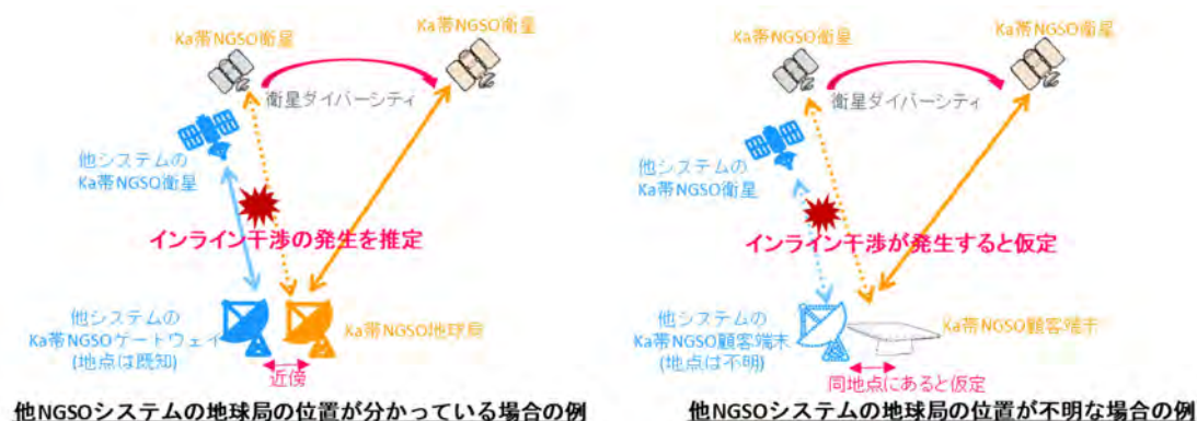
図 1. 2. 3-2 エフェメリスデータを用いたインライン干渉回避策
