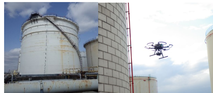
【ドローン等を活用した屋外貯蔵タンク等の点検イメージ】
