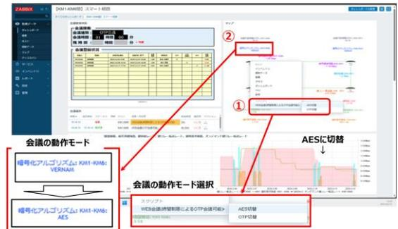
図 3-4-3 鍵蓄積量のモニタと暗号化モードの切り替えのためのユーザインタフェース画面
