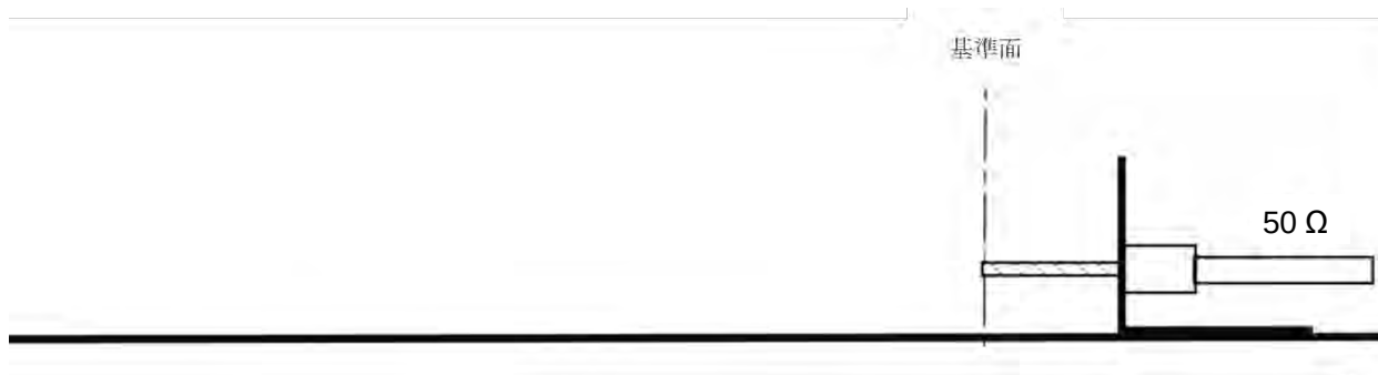
図 27b - 「反射」(ポート B) の校正測定系の構成
