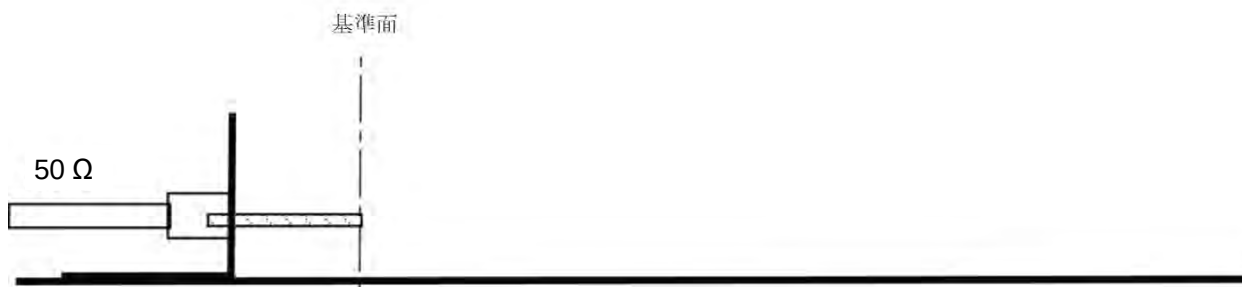
図 27a - 「反射」(ポート A) の校正測定系の構成
