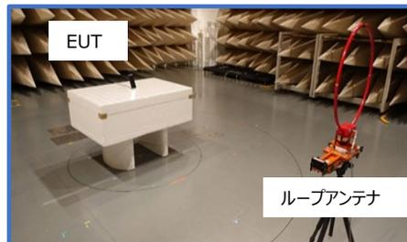
9 kHzから30 MHzまでの妨害波測定
