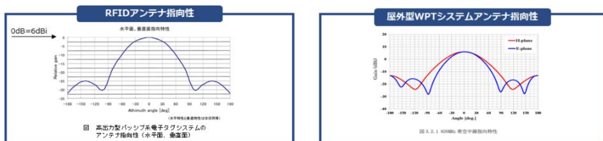
図 3.3.1 RFID 陸上移動局との指向性差※10
