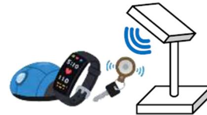
1m未満の近距離で低消費デバイスに給電（複数デバイスに位置制約なく同時給電可能）
