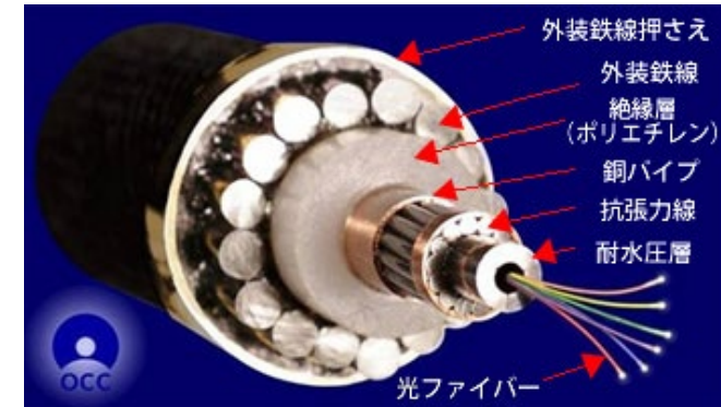
図1： 浅海 用ケーブルの構造 (水深 < 約1,500m)
