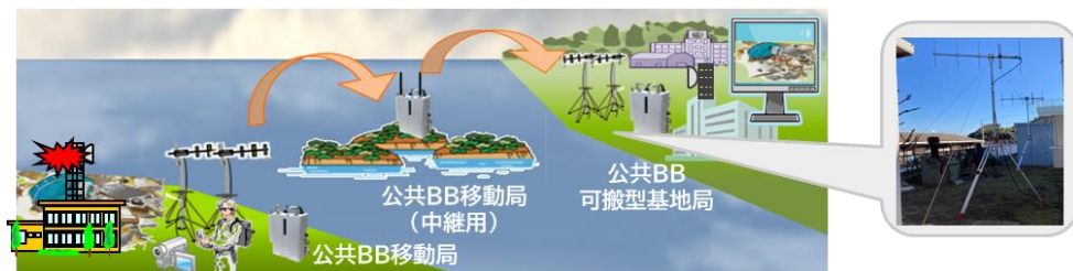
(b) 離島間のバックアップ回線として利用（1周波による多段中継運用イメージ）
