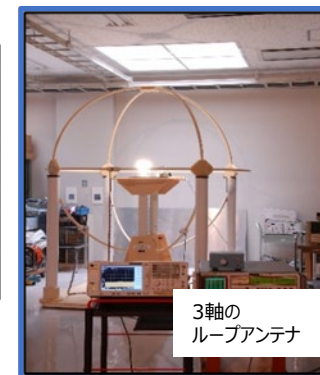
ラージループアンテナシステム (30MHz未満の妨害波測定で使用)
