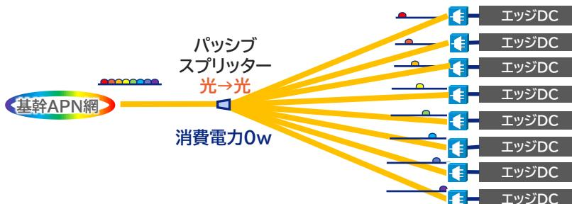
中継装置の電力は0、機器設置スペースも10%以下に
