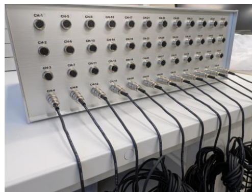
図 11 製作した 48 チャンネルアンプ回路ユニット
