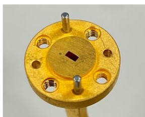
図 2 4 105 GHz 電界イメージング観察対象。 (WR-10 導波管)
