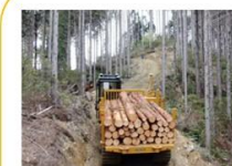
丸太を積載して上り坂を自動走行するフォワーダを開発・実証中
