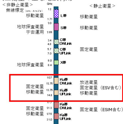
図表 1-8 : 人工衛星が発射する電波
