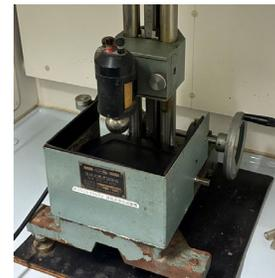
落球式打撃感度試験
