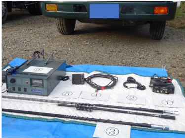
車両設置の不法無線局の実例
