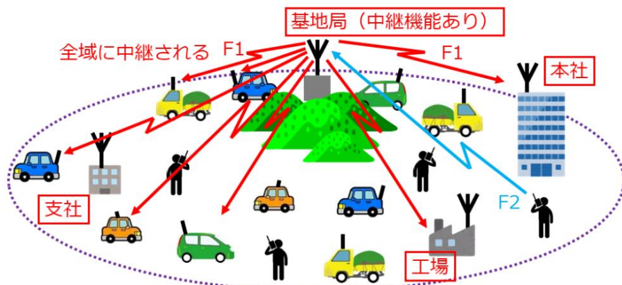
図 2-3 中継機能がある基地局における移動局間の通信
