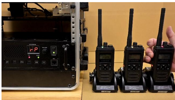
中継送信が開始され、無線機 C から音声が出る。無線機 B は無音。
