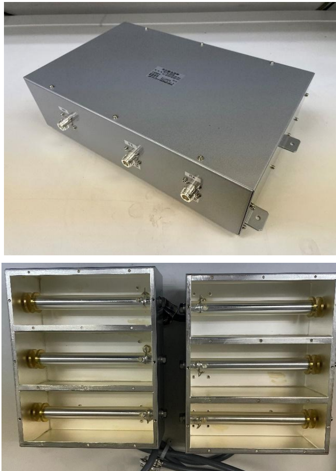
図 資料 11-3 空中線共用器の外観と内部
