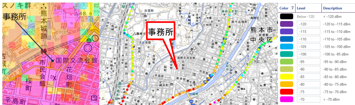
図 資料 8-19 中継から事務所への信号強度シミュレーション結果と測定結果
