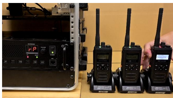
図 資料 7-14 障害検知・停止機能の確認結果(送信時間制限機能)
