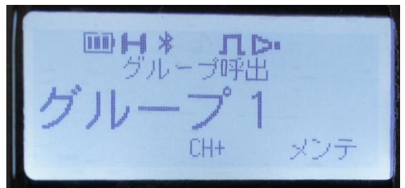
無線機 C には「グループ 1」の呼出であることを示す表示がされている。
