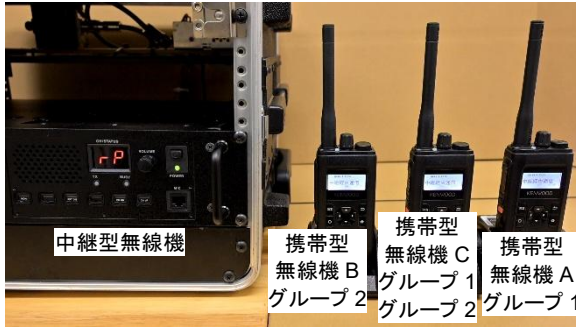
無線機の配置
