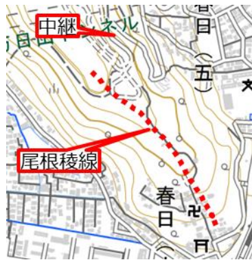
図 資料 8-5 中継機設置場所付近の地形
