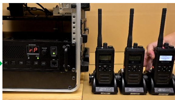
図 資料 7-14 障害検知・停止機能の確認結果(送信時間制限機能)
