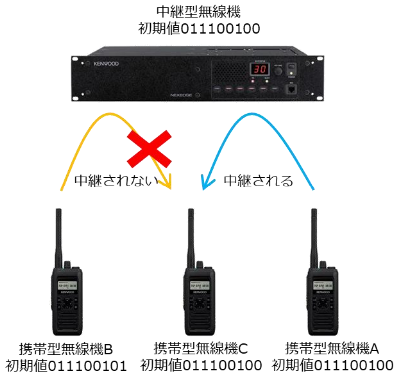
図 資料 7-2 スランブルコード(ホワイトニングコード)の確認方法
