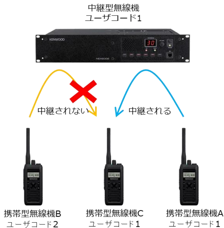
図 資料 7-4 ユーザコードの確認方法
