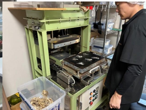
薄焼せんべい製造用 高圧縮熱板プレス機導入
