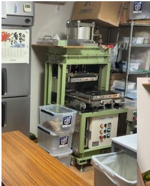
薄焼せんべい製造用 高圧縮熱板プレス機導入
