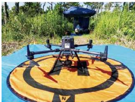
（サーマルカメラ搭載ドローン）
