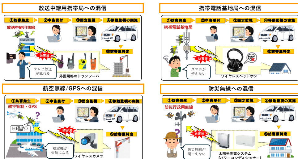
図表 1-8 : 重要無線通信への妨害及び対処の実例
