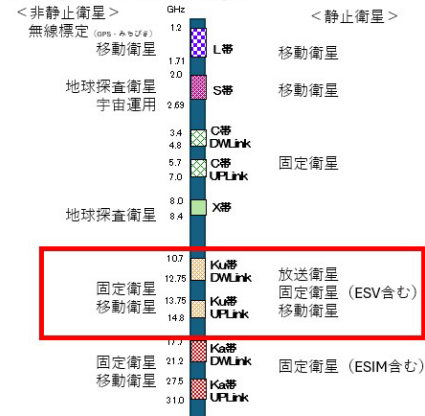
図表 1-12 : 人工衛星が発射する電波
