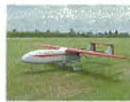
B-II (富士インバック) 翼長: 3.2m, 航続距離: 500km レシプロエンジン 価格: 1000~2000万円/システム
