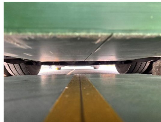
EVバス停車時の送受信コイルの様子
