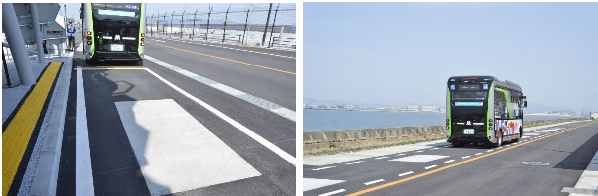
図 3-3 来場者移動用バス向け SWPT(左)および DWPT(右)システム
