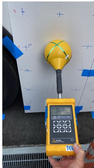
図 4-52 車両左後部での磁束密度分布測定状況
