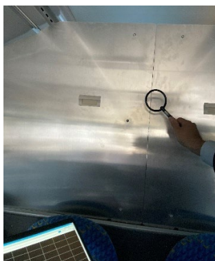
(a) 可搬型測定器を用いた磁界強度の確認
