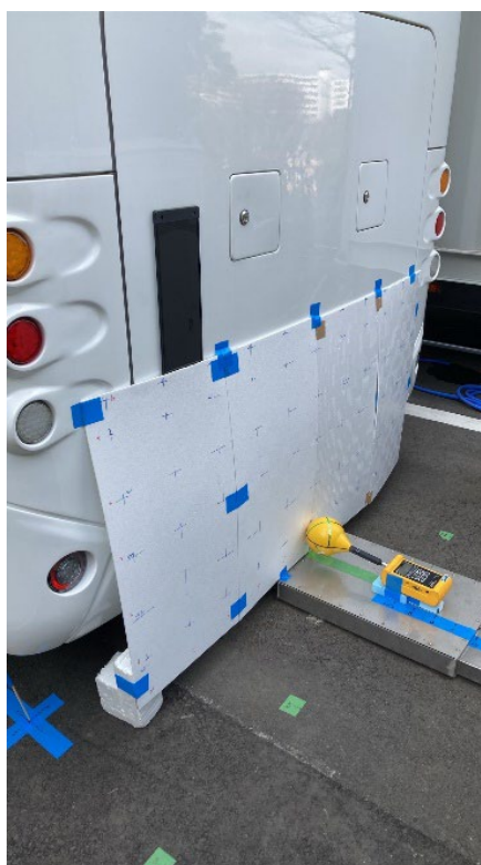
図 4-51 車両後部での磁束密度分布測定状況
