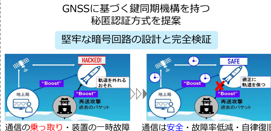
宇宙ロケット制御用無線通信に適用する 暗号回路の宇宙環境下における堅牢性と信頼性の向上
