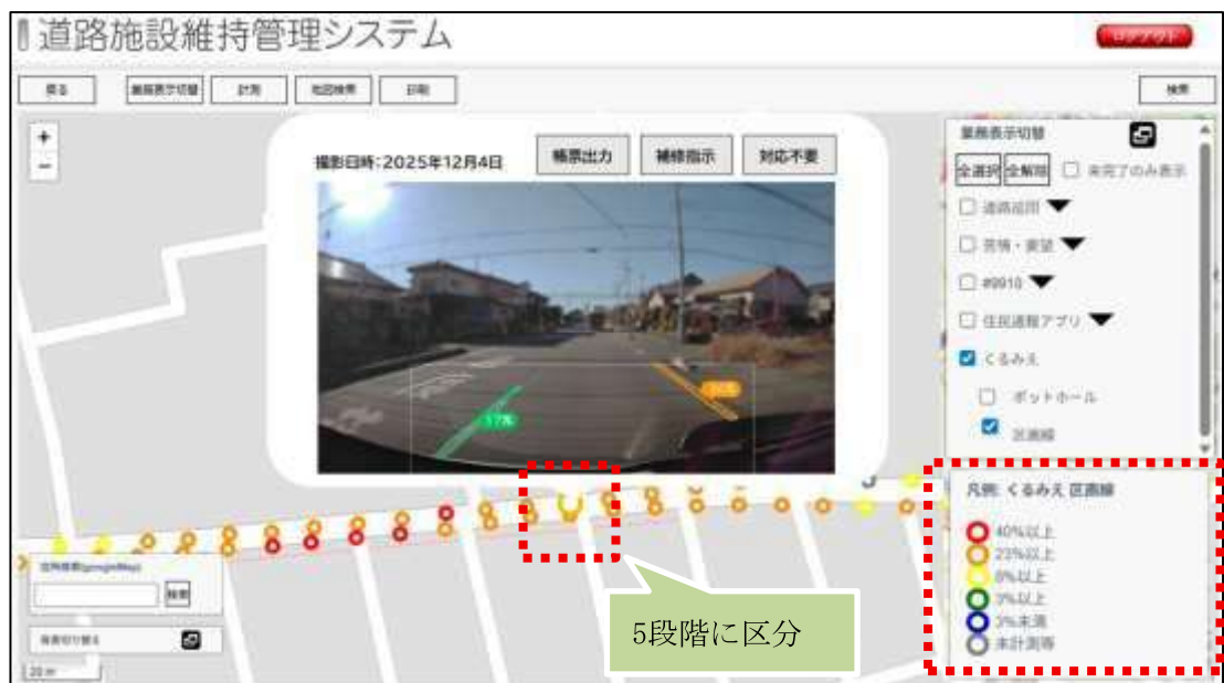
図 2-13：道路施設維持管理システム 白線かすれ確認
