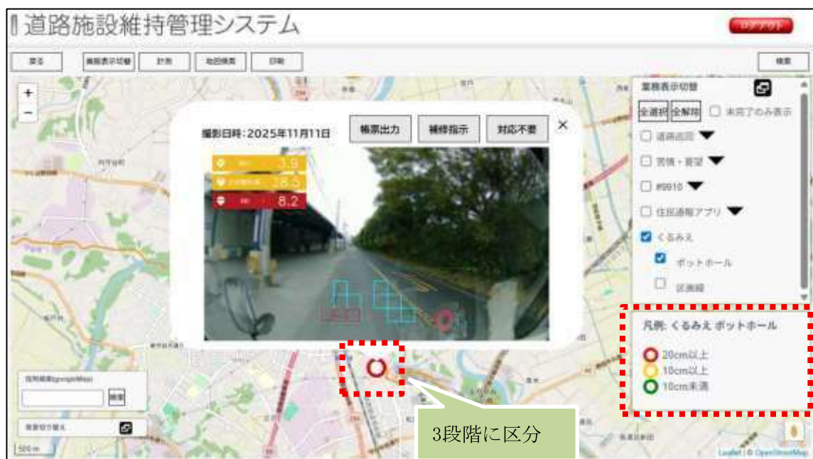
図 2-11：道路施設維持管理システム ポットホール確認
