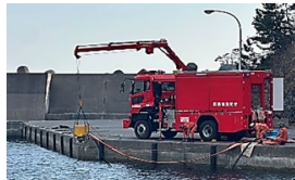
海水利用型消防水利システム (スーパーポンパー)
