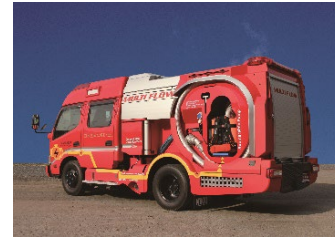
大容量小型ポンプ車
