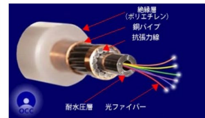
図2：深海用ケーブルの構造 (水深 > 約8,000m)
