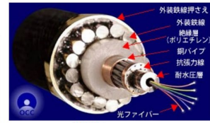
図1：浅海用ケーブルの構造 (水深 < 約1,500m)
