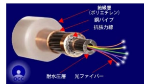
図2：深海用ケーブルの構造 (水深 > 約8,000m)
