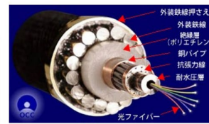
図1：浅海用ケーブルの構造 (水深 < 約1,500m)
