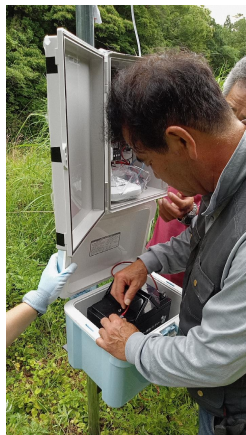
① カメラセンサー機器類の組み立て
