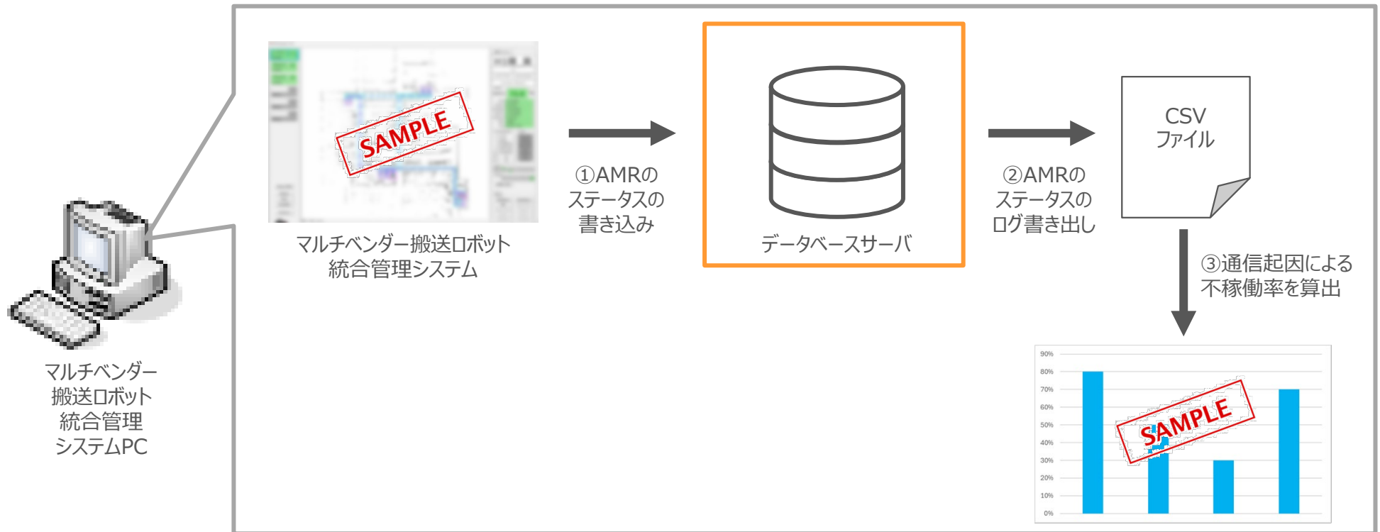
図IV-3-15 通信起因によるAMR不稼働率のログ取得方法時の実証フィールドにおける構成
