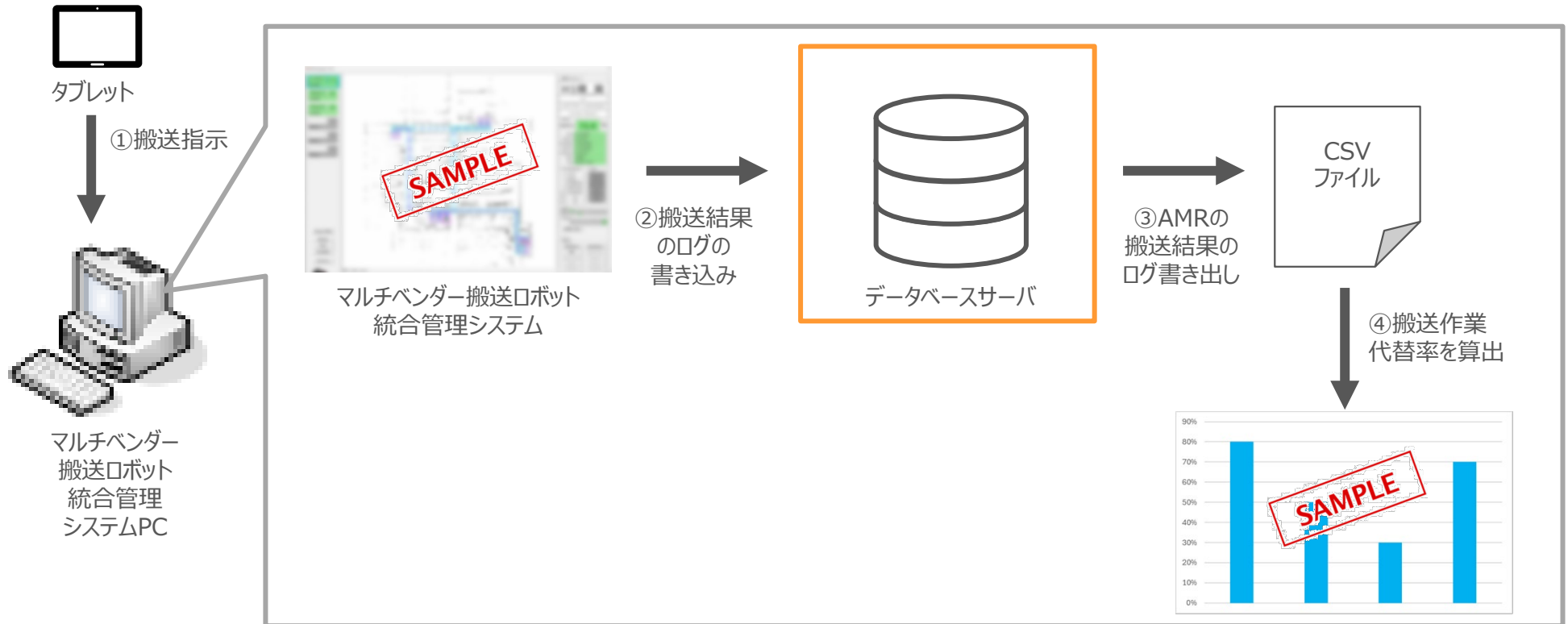
図IV-3-9 搬送作業代替率のログ取得方法時の実証フィールドにおける構成
