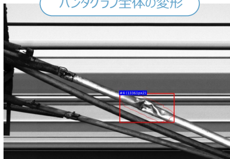
屋根上機器の变形
