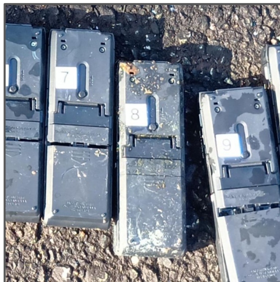
録音機材の腐食・劣化状況
