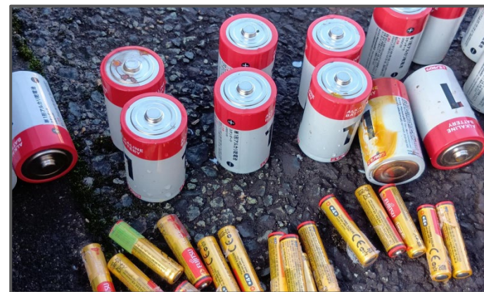
機材駆動用バッテリーの腐食・劣化状況
