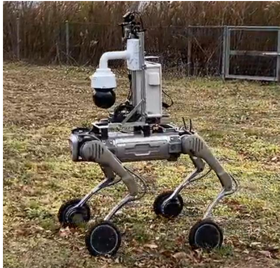
図 8.3-1 カメラ・エッジ AI と遠隔制御システムを搭載した四足歩行ロボット
