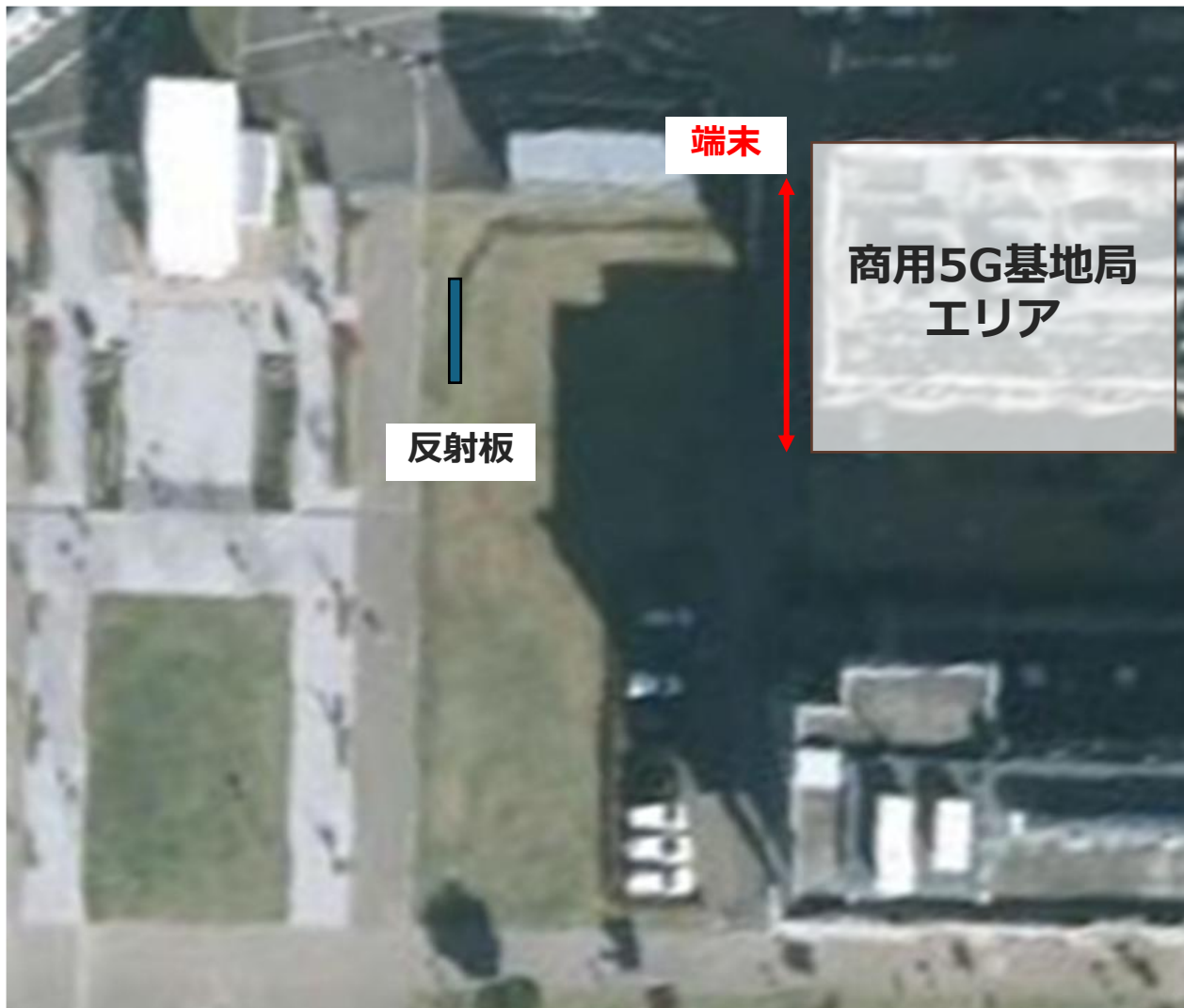
図 6.3-4 28GHz メタサーフェス反射板設置位置と測定ラインの関係
