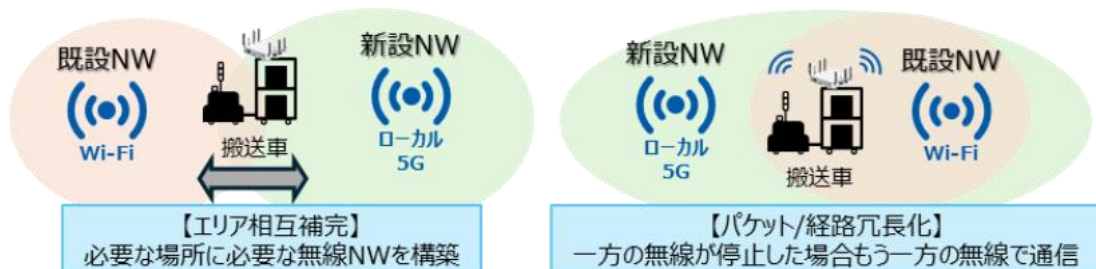
図 3.1-3 ハイブリッドネットワークの概念図
