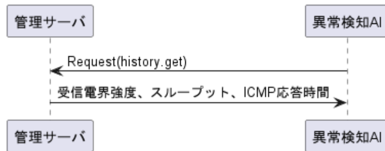
図 4.2-9 異常検出 AI が学習およびリアルタイム推論用に使うデータのデータフロー
