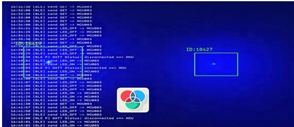
図 6-3-3 2 台の OCC 通信機の LED 光源が散乱・拡散して混在している様子 (OCC 中継機の受信スマートフォンに映った映像)
