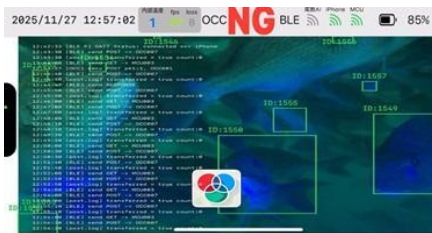
図 6-3-9 OCC 通信が魚群に遮られている様子
