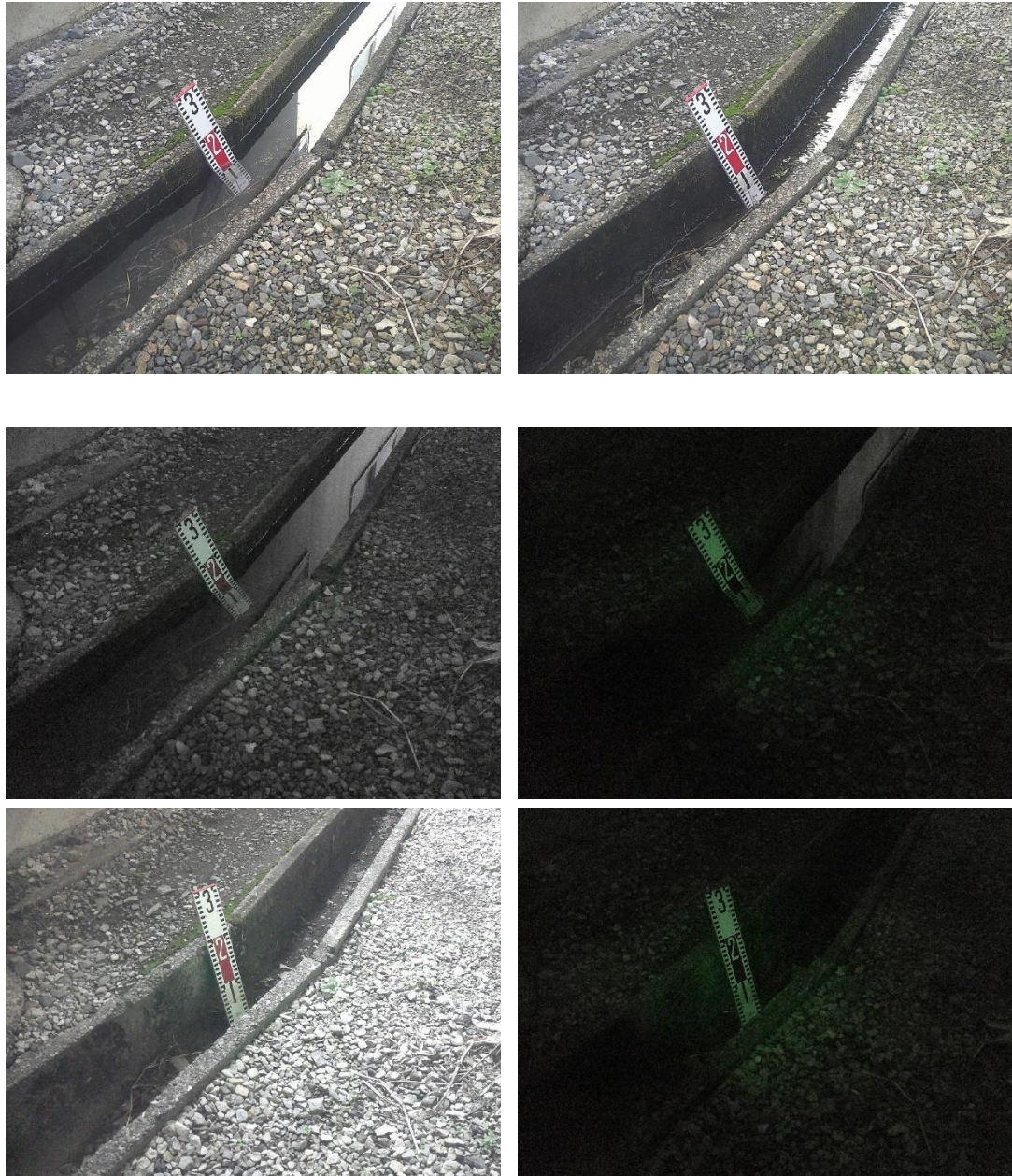
図 8.4-1 排水溝水位画像の例
