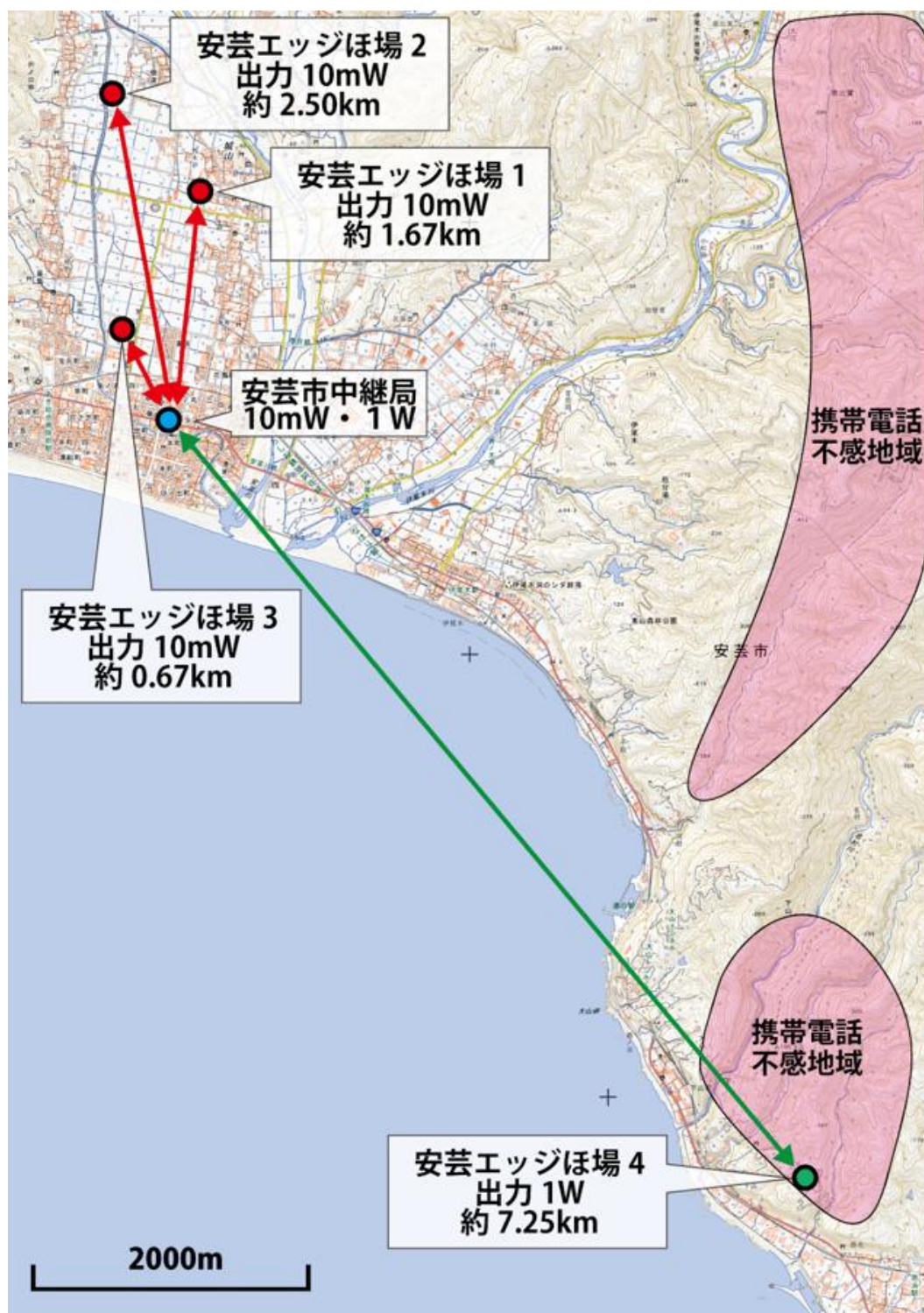
図 8.2-3:高知県安芸市周辺の設置状況
