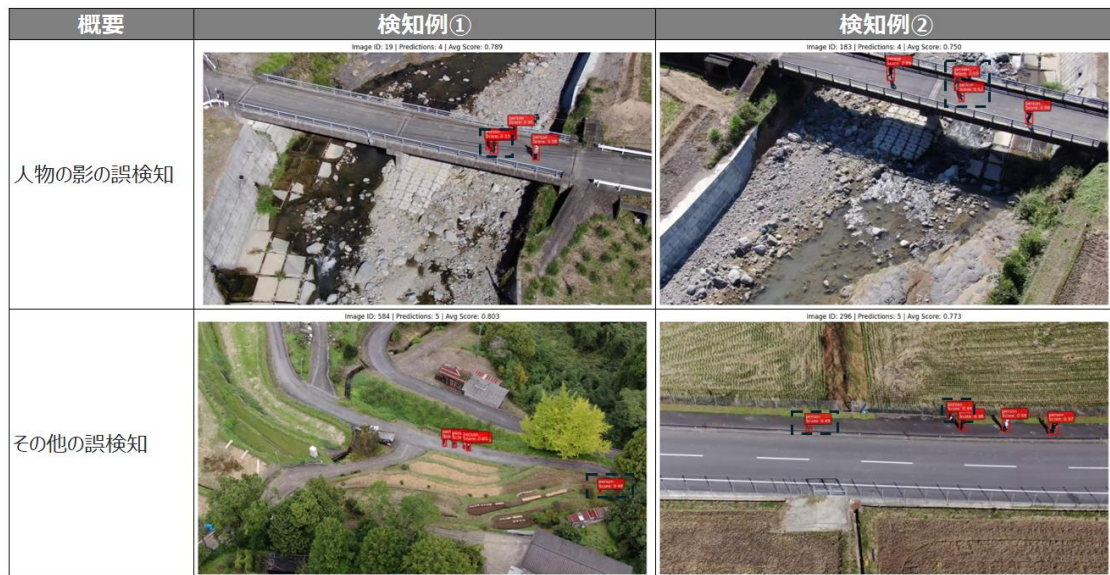
図 39 人物検知 AI の誤検知例
