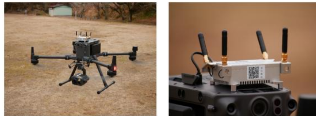
図 13 ドローンに搭載するスマートドローンアタッチメントのイメージ
