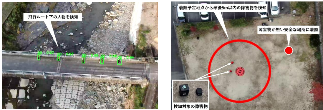
図 53 エッジ AI による地上リスク検知のイメージ
