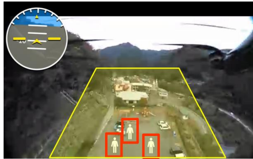
図 5 飛行ルート下の地上リスク 人の集中 検知のイメージ (黄色枠: 検知対象範囲、赤枠: 人の検知結果)
