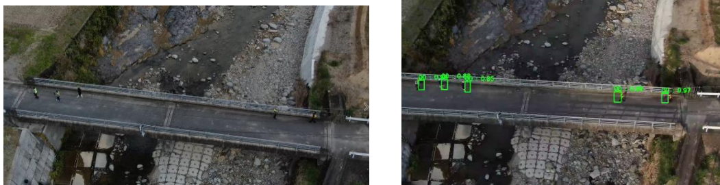
図 34 左図:AI 検知無し。人なのか、風景なのか、注視している間にもドローンは進んでしまう 右図:AI 検知有り。マーカがある注視するポイントが絞られ、認知速度が向上する
