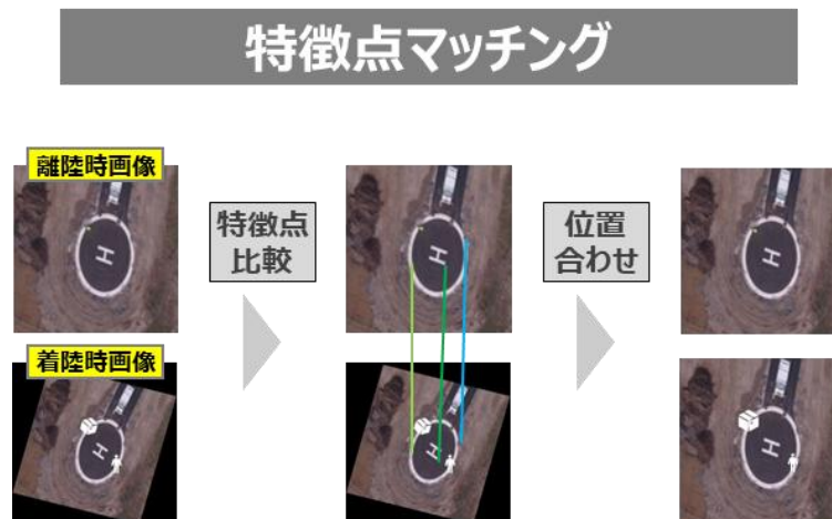
図 21 特徴点マッチングの処理イメージ
