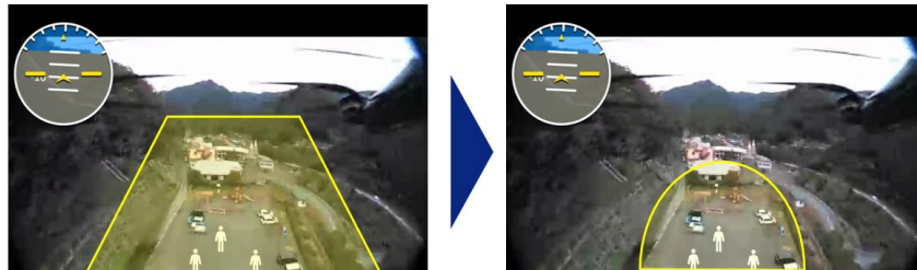
図 10 落下分散範囲を特定しない場合の検知対象範囲(左図黄色部)と、落下分散範囲を特定する場合の検知対象範囲(右図黄色部)のイメージ
