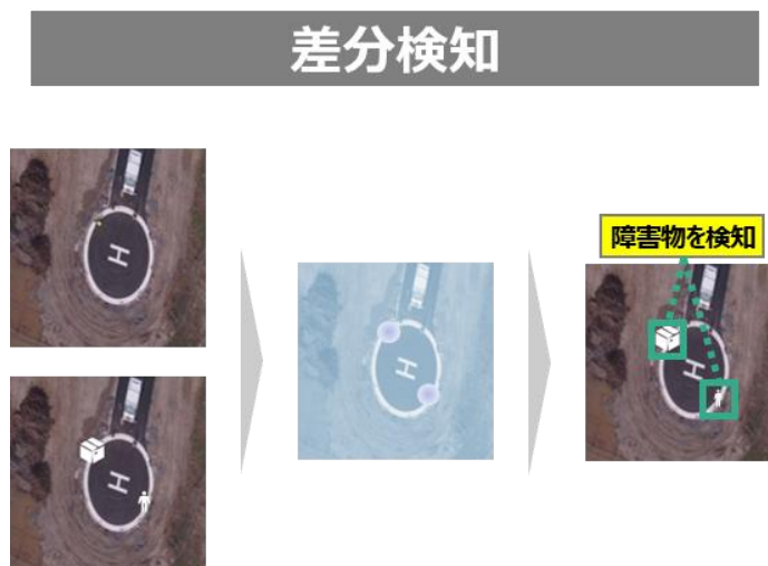
図 22 差分検知の処理イメージ
