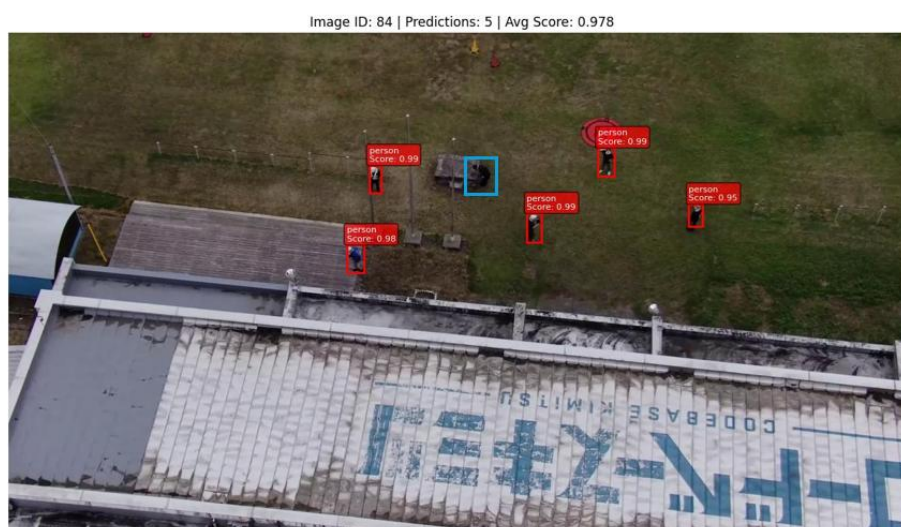
図 45 人物ID77の検知漏れ例
