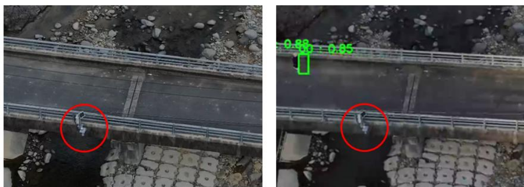
図 35 左図:AI 検知無し。別の対象物を第三者か否かを判断するケースも存在する 右図:AI 検知有り。別の対象物が近くにあっても、第三者に注意を向けることが可能である
