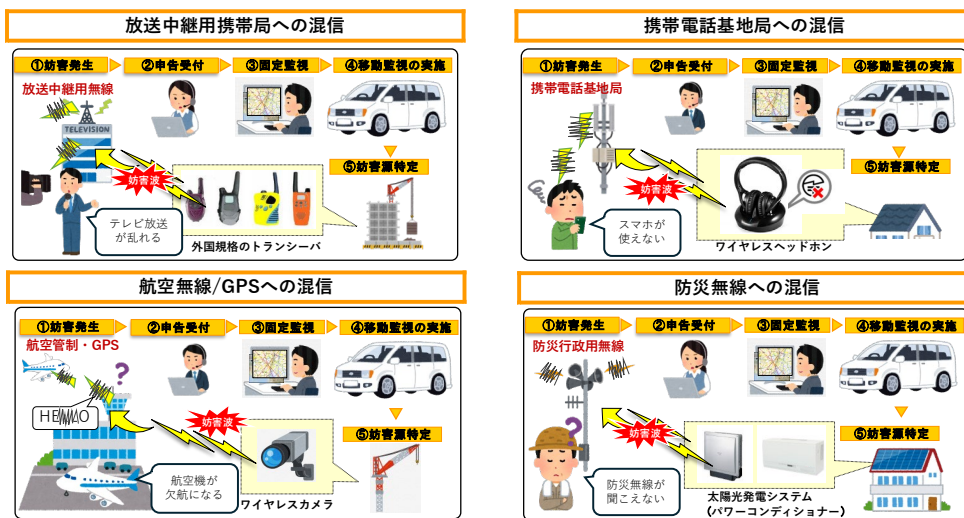
図表 1-8 : 重要無線通信への妨害及び対処の実例
