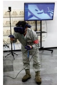
VRによる溶接作業事前検証
