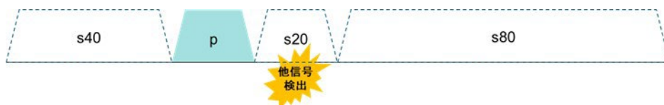
図 3-5 160 MHz チャンネル幅使用時に secondary 20 MHz channel に他信号があり、ビジーとなる場合の従来送信例
