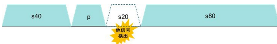
図 3-6 160 MHz チャンネル幅使用時に secondary 20 MHz channel に他信号があり、ビジーとなる場合のパルクチャリング適用送信例
