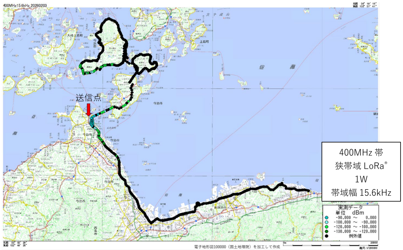
図 4-72 400MHz 帯狭帯域 LoRa®1W 拡散係数 SF=7 帯域幅 15.6kHz
