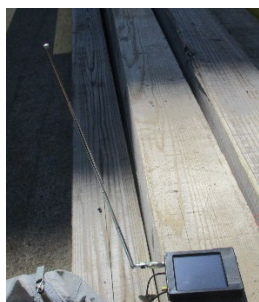
図 4-124 スペクトラムアナライザでのノイズ測定状況
