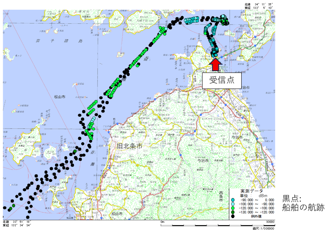
図 4-131 船体ブロック位置管理システム 400MHz 帯狭帯域 LoRa® 動作確認結果
