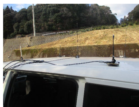
図 4-81 走行ルート3 ドライブテスト測定状況
