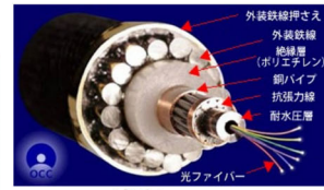
図1：浅海用ケーブルの構造 (水深 < 約1,500m)
