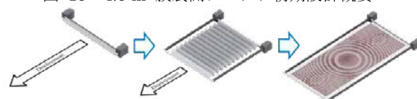
図 16 4.5 m 2 膜展開アンテナ展開方法
