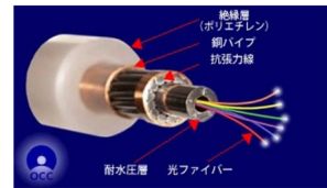
図2：深海用ケーブルの構造 (水深 > 約8,000m)
