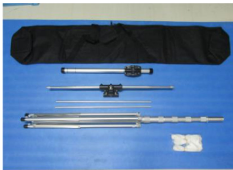
アンテナ（組立前）
