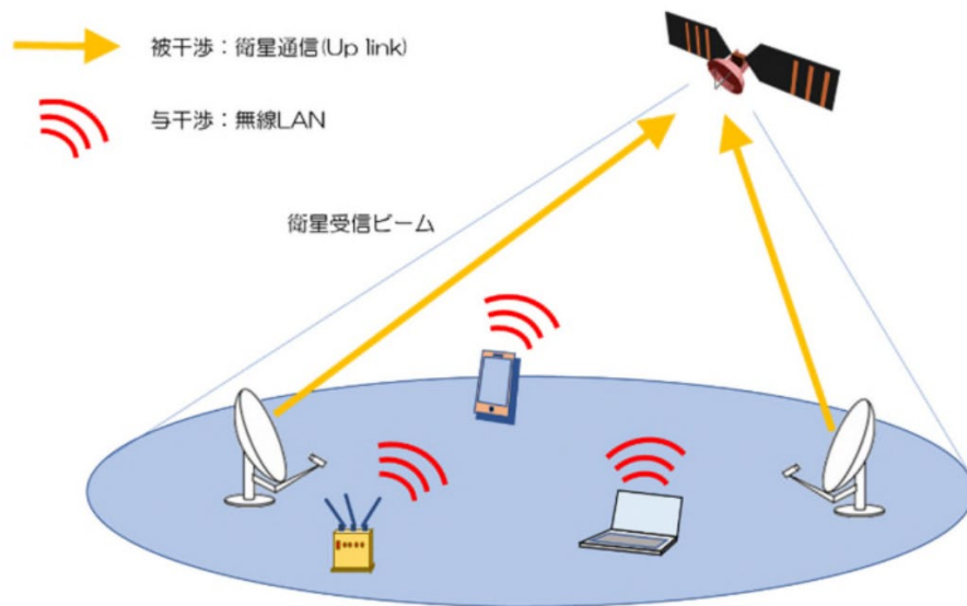
図 2－8：無線 LAN から静止衛星システム（Up link）への干渉モデル
