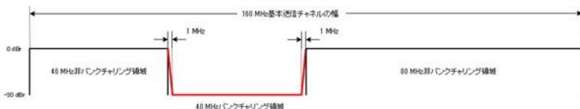
図 3-12 160 MHz チャンネルにおいて 40 MHz チャンネルをパンクチャする場合
